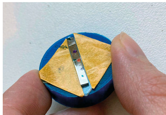
Obr. 6 Krystal slitiny Ni-Mn-Ga s viditelnými zlomy v bodech suprapohyblivých rozhraní. Foto: Kristýna Repčák, ÚT AV ČR
