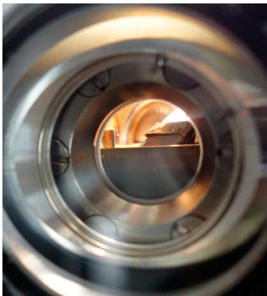
Obr. 5 Vzorek slitiny Ni-Mn-Ga při měření v teplotní komoře. Na povrchu vzorku je vidět červený bod měřícího laseru. Foto: Jan Zidek, ÚT AV ČR
